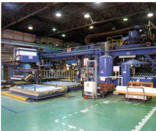
Рис.1. Производственная линия вакуум-пленочной формовки на Asuzac Group
