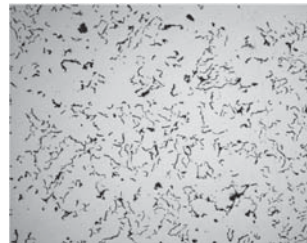
Рис. 16. Морфология графита, характерная для 1-го кулачка, предмодифицирование в чаше FC75л3, модифицирование в форме FC50P3M20, x100
