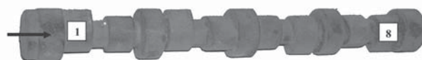
Рис. 1. Общий вид отливки детали «Вал распределительный» (1 и 8 – номера кулачков в направлении поступления металла)
