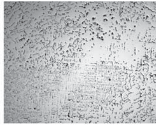
Рис. 11. Морфология графита в чугуне, характерная для 8-го кулачка, модифицирование в форме FC50P3M20, x50
