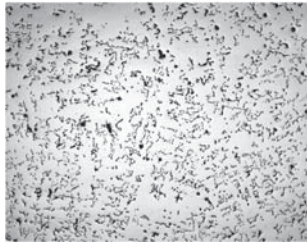
Рис. 10. Морфология графита в чугуне, характерная для 1-го кулачка, модифицирование в форме FC50P3M20, x50
