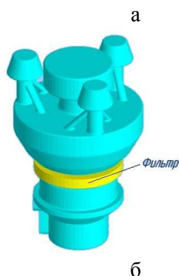
Рис. 2. Схема двухфазного состояния сплава - а); эскиз отливки со встроенным в литниковую систему фильтрующим устройством - б)
