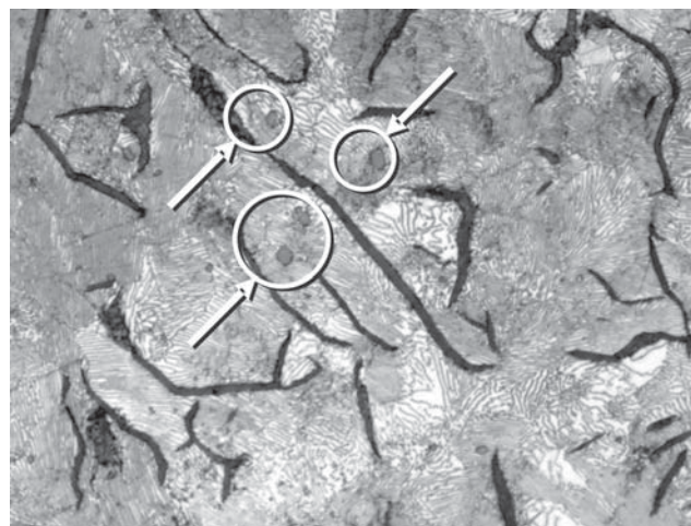
Микроструктура чугуна Gh190 при содержании серы 0,12%, х500 (включения сульфида марганца показаны стрелками)
