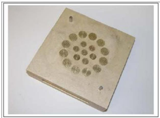
*Рисунок 5 – Пластина В (новая) с 12x16мм, 0.3мм щелевидными вентилями и 7x12мм, 0.3мм щелевидными вентилями. Открытая площадь вент = 577мм<sup>2</sup>*
