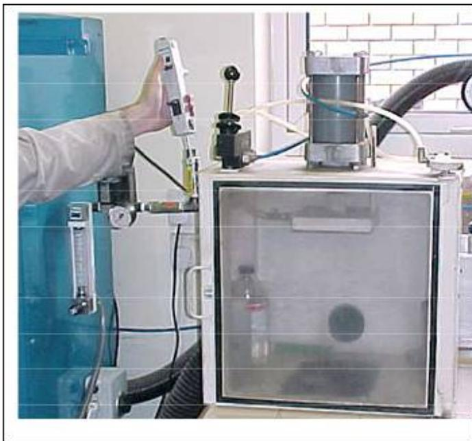
Рисунок 2 – Камера подачи амина, с микропипеткой для инъекции амина и линией подачи несущего газа с расходомером.
